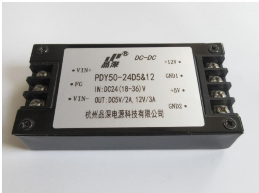
电源模块就是一种小型的开关电源，主要分为AC-DC电源模块和DC-DC电源模块。因为体积小，通常要加外面元件使用，主要作为电压转换作用，为系统供电，不具有充电功能。电源模块种类很多，多数是采用开关电源设计，主要的目的还是为了减轻重量和减小体积。与普通电源的作用差不多，只不过在功能上会多了一点及功率密度很高。电源适配器是指给设备提供电能的电源，如电脑主机电源、打印机电源、显示器电源，这些不叫充电器。电源适配器具有体积较小、节能环保、多重安全保护、使用寿命长、应用范围广等特点，大致可分为桌面式电源适配器、直插式电源适配器、多路电源适配器、USB电源适配器等。电源适配器包括充电器，但是充电器不包括电源适配器。云南单路dc-dc电源模块价格如何选择高可靠性的DC-DC模块电源？
